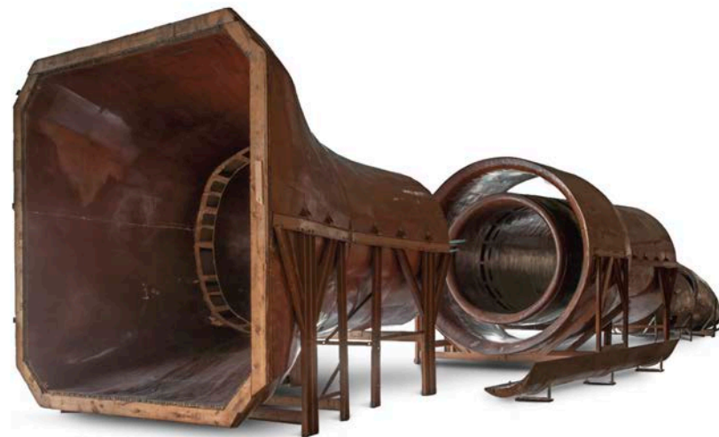
新中国首座大型低速回流风洞 1958年 通高700厘米，通长4450厘米
